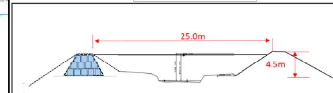
**(2)** 右岸 決壊延長L=10m 高さH=4.5m 応急復旧完了 (7/17)
