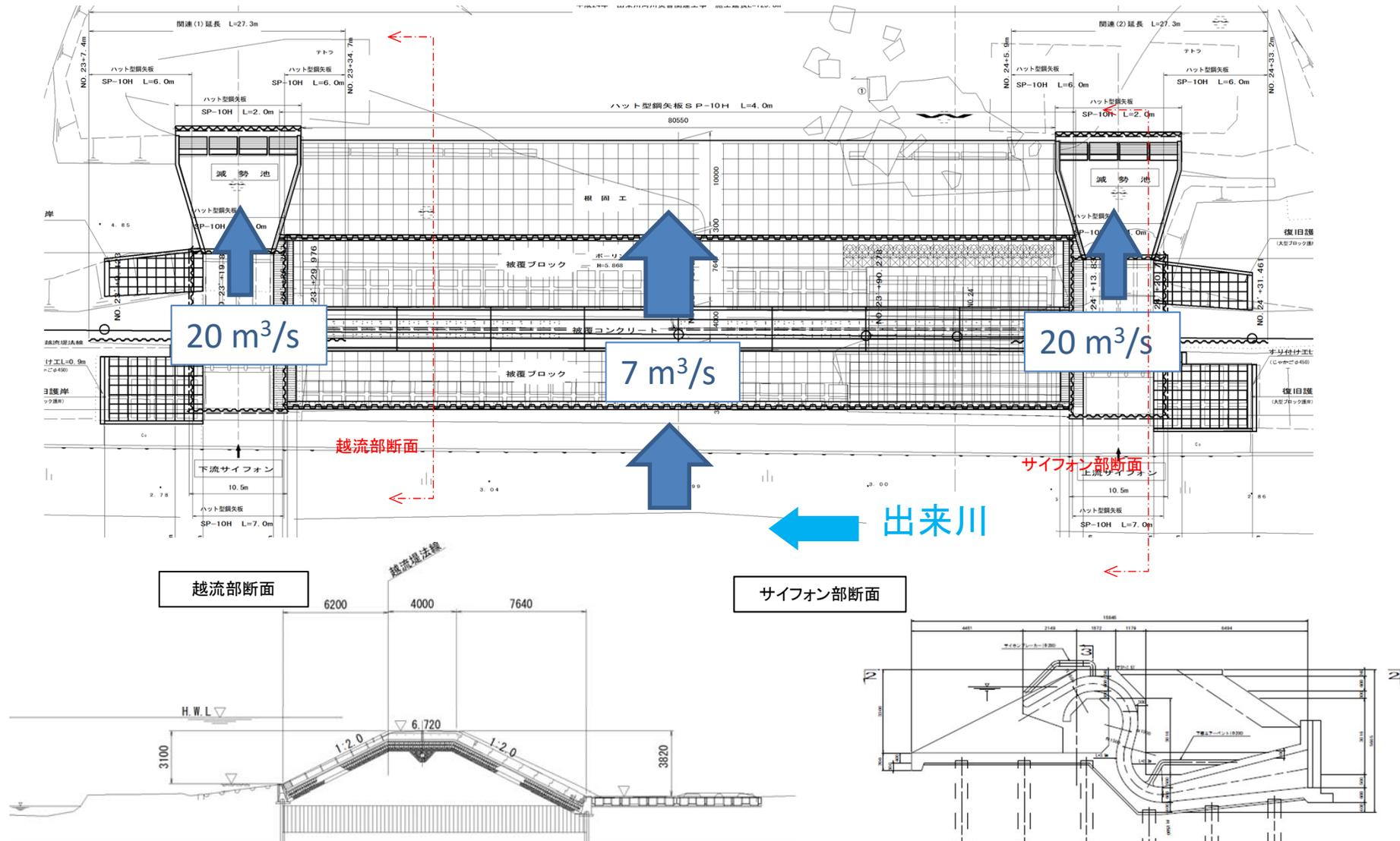
名鱒沼越流堤は出来川の水位上昇に伴い、越流堤から最大 $7\text{m}^3/\text{s}$ 、サイフォンよりそれぞれ最大 $20\text{m}^3/\text{s}$ の排水を行うことができる。
